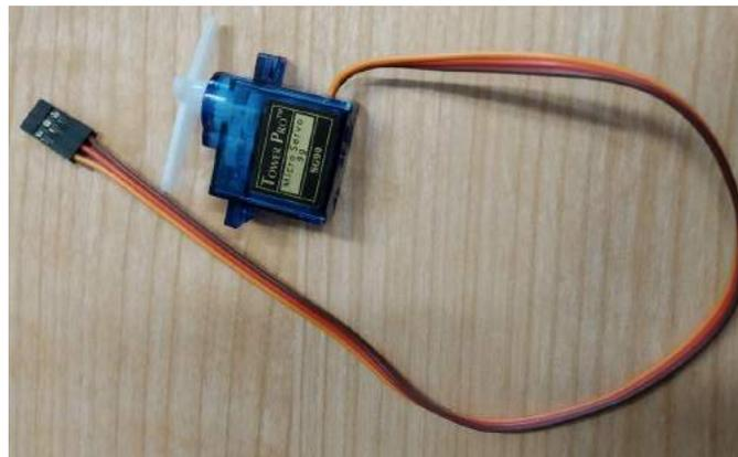
Figure 5: Servo RC 1,2 kg\*cm
